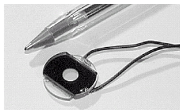
Рис. 13. Адаптивная ЖК-линза с беспроводным управлением.
