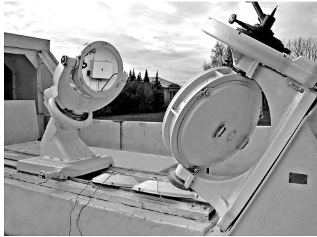
Рис. 1. Откатная часть телескопа с целостатом.
