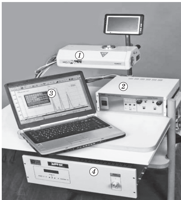
Рис. 1. Анализатор “Х-Арт М”. 1 – аналитический блок с видеокамерой, расположенные на штанге (блок может вращаться в вертикальной и горизонтальной плоскостях), 2 – блок питания рентгеновской трубки, установленный на передвижном столе, 3 – ноутбук для управления работой прибора, 4 – блок питания и охлаждения детектора и спектрометрическое устройство (размещены в нижней части приборной стойки).
