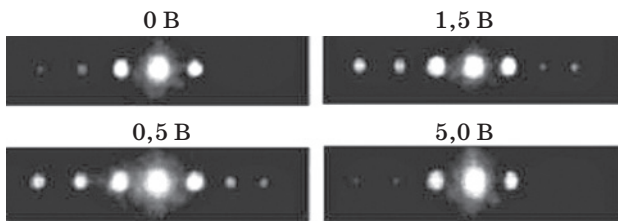
Рис. 1. Фотографии дифракционной картины на выходе ЖК-элемента при различных напряжениях.
