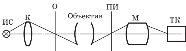
Рис. 1. Принципиальная оптическая схема измерительной установки. ИС – источник света, К – конденсор, О – тест-объект, ПИ – плоскость изображения тест-объекта, М – вспомогательный микроскоп, ТК – телекамера.
