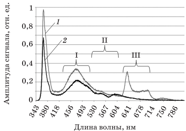
Рис. 4. Экспериментальные спектры эндогенной флюоресценции, снятые in vivo на диагностическом комплексе «ЛАКК-М» при возбуждении флюоресценции узкополосным излучением УФ светодиода с максимумом в линии \lambda = 365 \text{ нм} . 1 – кожа хвоста крысы, 2 – слизистая оболочка мягкого неба человека. I – область флюоресценции коллагена, эластина, NADH, кератина и т.д.; II – область флюоресценции флавопротеинов и липофусцина, III – область флюоресценции порфиринов.
