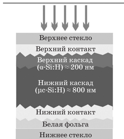
Рис. 2. Структура двухкаскадного тонкопленочного солнечного элемента [2].
