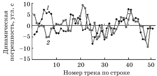
Рис. 4. Графики угловой динамической погрешности по X нечетных (1) и четных строк (2).
