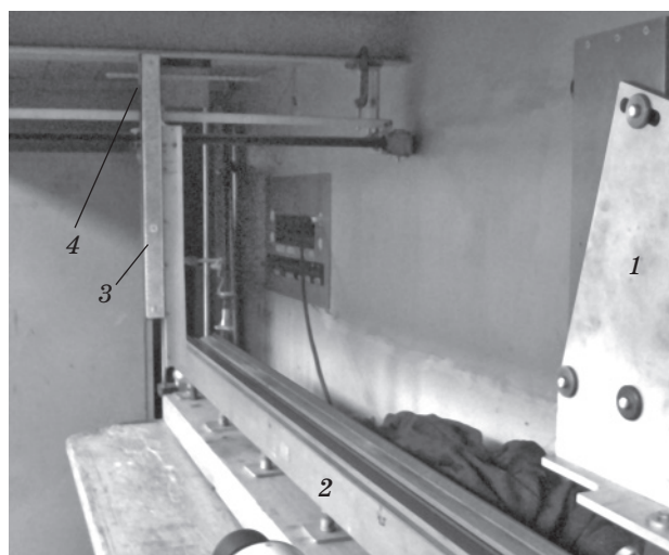
Рис. 3. Расположение блоков системы на измерительном стенде. 1 – измерительный блок, 2 – оптическая скамья, 3 – реперная метка, 4 – специальная подвижка.
