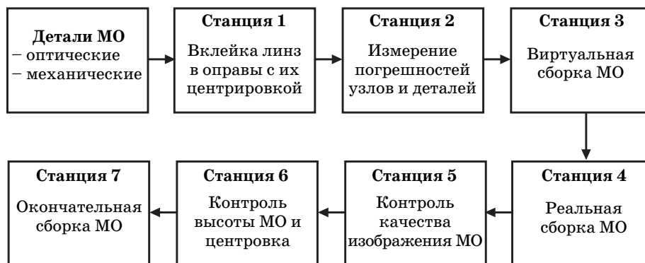
Рис. 4. Структурная схема автоматизированной линии сборки.
