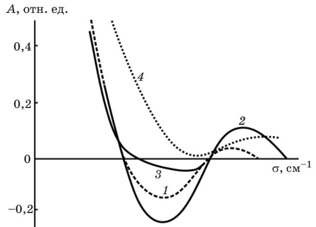
Рис. 2. АФ сканирующего двухлучевого интерферометра с параллелограммной направляющей. 1 - измеренная (спектр излучения He-Ne-лазера на  $\lambda = 3,39 \text{ мкм}$ ), 2 - вычисленная по формуле из [4], 3 - вычисленная по уравнению с аппаратной аподизацией  $A = J_1(4\pi\sigma_0 r \delta \Delta\beta/\hat{\delta}) / (4\pi\sigma_0 r \delta \Delta\beta/\hat{\delta})$ , 4 - АФ с треугольной аподизацией первой степени  $1 - \delta/\hat{\delta}$ .
