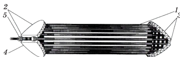
Рис. 1. Оптическая схема излучателей многоканальных волноводных CO 2 -лазеров диффузионного охлаждения. 1 – газоразрядные трубки, 2, 3 – поворотные зеркала, 4 – заднее зеркало резонатора, 5 – выходное зеркало резонатора.
