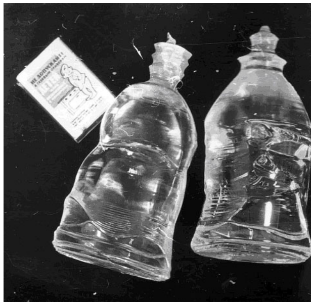
Первые кристаллы сапфира, выращенные методом ГОИ (осень 1971 г.).
