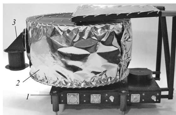
Рис. 2. Макет образца прибора “АОСТ”. 1 – база, 2 – башня, 3 – головка наведения.
