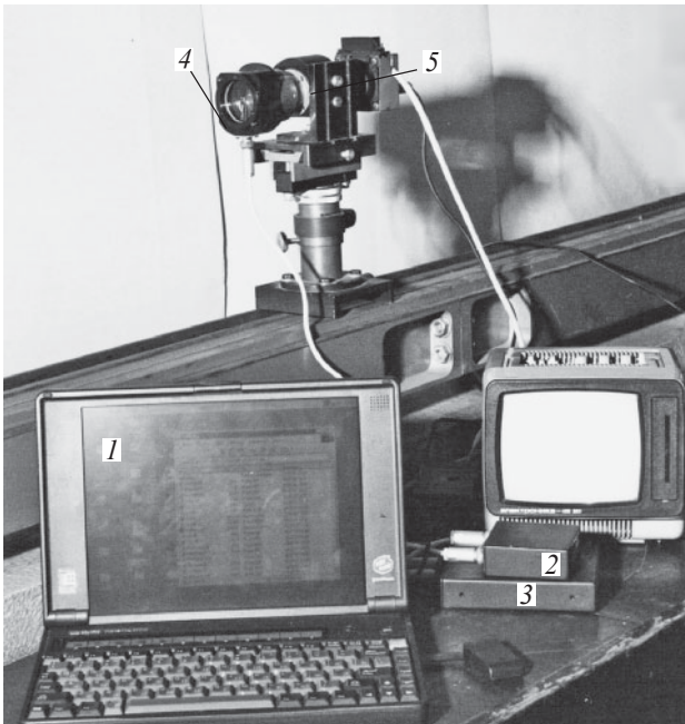
Рис. 3. Общий вид авторефлексионной ОЭС. 1 – центральный блок обработки информации, 2 – блок предварительной обработки информации, 3 – блок управления светодиодами, 4 – излучающая головка, 5 – приемная оптическая головка.
