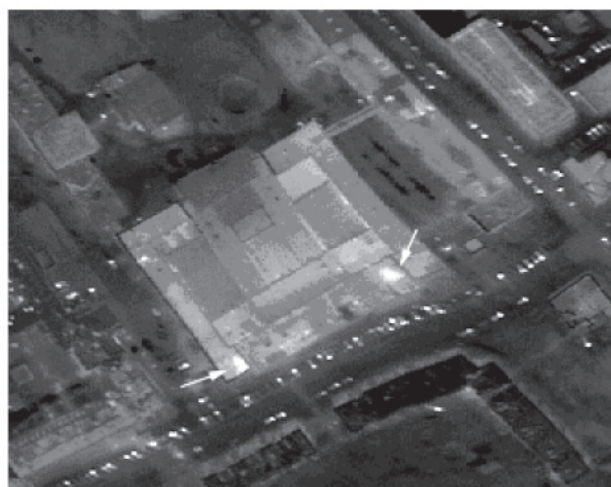
Рис. 1. Тепловой аэроснимок участка старой застройки. Видны интенсивные локальные аномалии на углах здания (наилучшая наглядность имеет место в цветной палитре).
