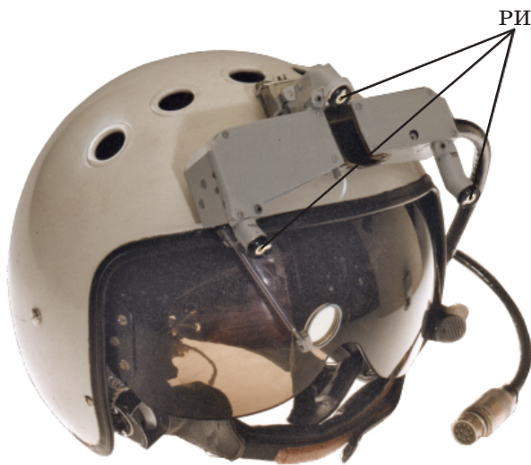
Рис. 3. Узел НСЦ “Сура” (КП СПС “Арсенал”, Украина). РИ – реперные излучатели.
