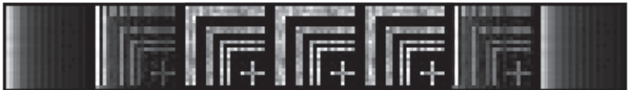
Рис. 8. Восстановленные изображения, полученные с помощью отражательных рельефно-фазовых голограмм с различной высотой поверхностного рельефа (слева направо: 0 ; 0,02\lambda ; 0,2\lambda ; 0,25\lambda ; 0,3\lambda ; 0,48\lambda ; 0,5\lambda ).
