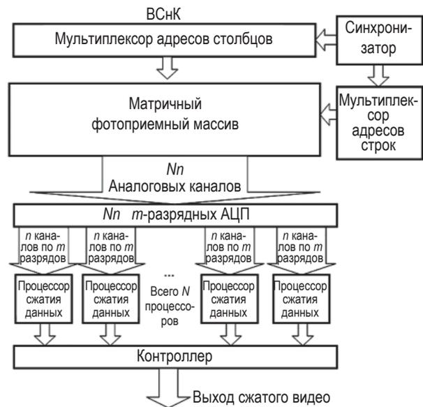
Рис. 4. Функциональная схема распараллеливания считывания и вычислений в видеосистеме на кристалле с кодированием источника.
