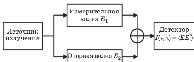
Рис. 1. Принципиальная схема системы корреляционной ОКТ.
