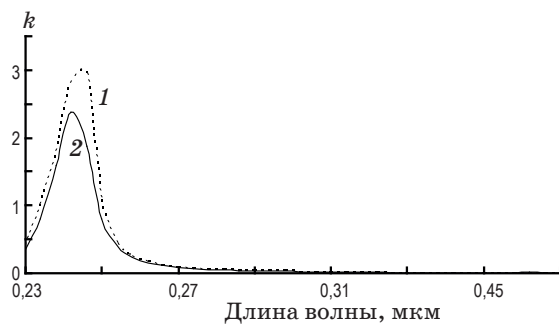
Рис. 3. Дисперсионные зависимости показателя поглощения пленки \text{Ta}_2\text{O}_5 для модели ФБ (1) и ФБ(м) (2).
