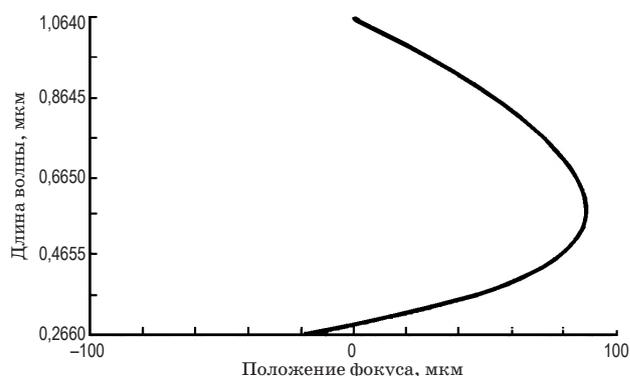
Рис. 4. Остаточный хроматизм положения фокуса ахроматического объектива расширителя лазерного пучка.
