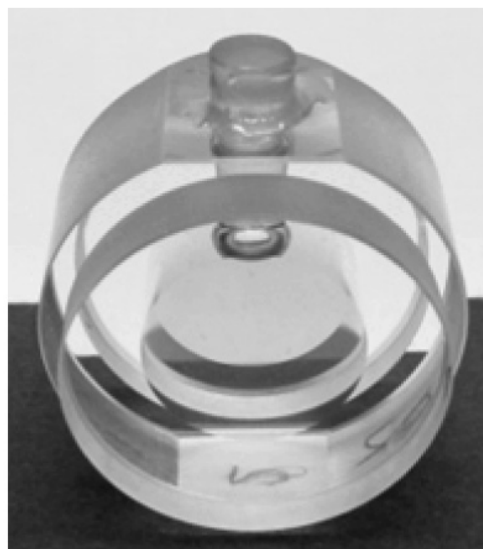
Рис. 4. Фотография кюветы фильтра НОМ-Ф-1.
