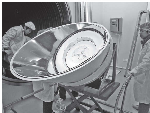
Рис. 2. Внешний вид собранного излучающего радиационного холодильника.
