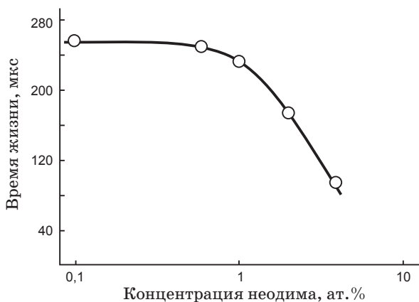
Рис. 5. Зависимость времени жизни возбужденного состояния от концентрации активатора (неодима) в лазерной керамике Nd:YAG [16].
