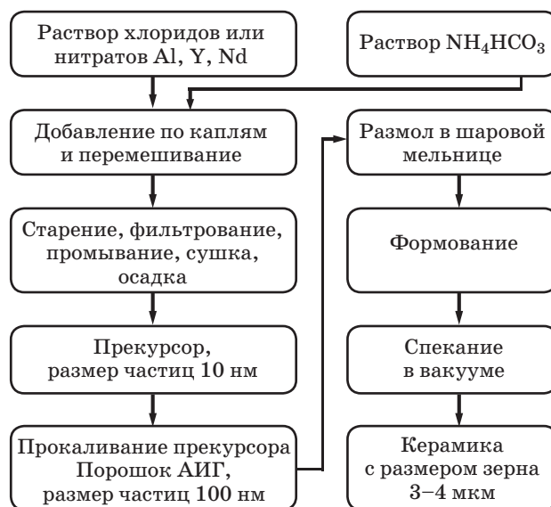
Рис. 7. Технологический процесс синтеза АИГ-керамики гидрокарбонатным методом [38].
