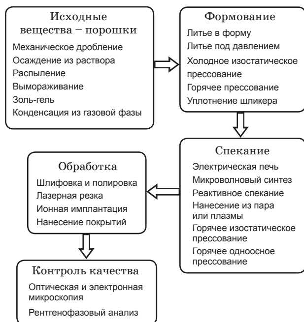
Рис. 1. Схема технологического процесса получения специальной керамики.
