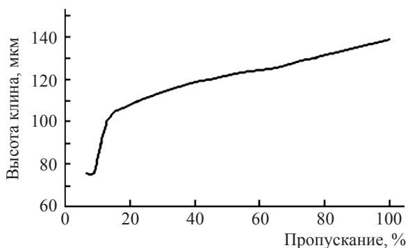
Рис. 5. Зависимость высоты профиля оптической поверхности от оптического пропускания фотошаблона (фотометрический клин) для композиции № 3 (табл. 2).
